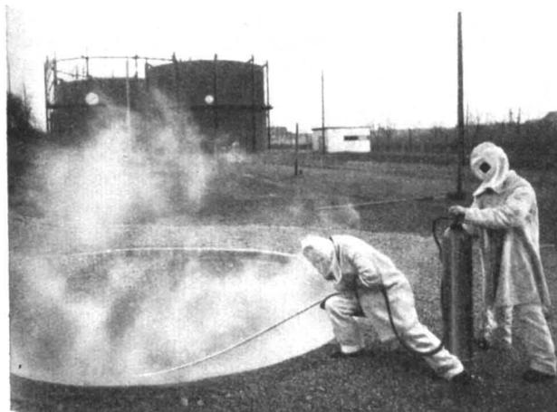
Bild 5. Löschen des Brandes mit in einen Asbestbeutel gedrückter Kohlensäure. Die Schneebildung auf der Rohrstange ist deutlich erkennbar.
