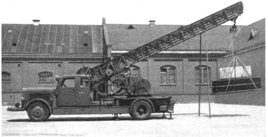
Bild 12. Kraftfahrleiter als Kran mit Stütze, Belastung 1800 kg, Ausladung 3,70 m, Neigung 25 Grad.
