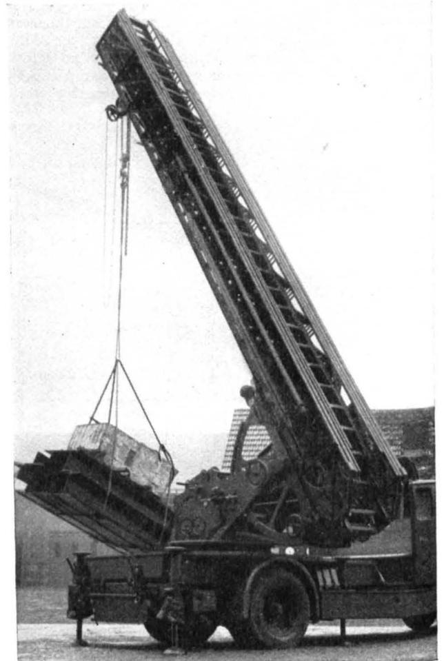
Bild 11. Kraftfahrleiter als Kran ohne Stütze, Belastung 1800 kg, Ausladung 1 m, Neigung 60 Grad.
