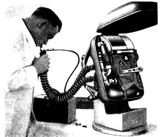
Bild 8. Zu Prüfungsvorgang 5: Ermitteln des Anspringdruckes des lungenfähigen Sauerstoffzuschusses im Heeresatmer.
