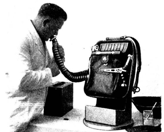
Bild 28. Zu Prüfungsvorgang M: Ermitteln des Spiels der Atemventile durch Beatmen des Heeresatmers.
