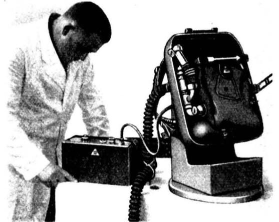
Bild 7. Zu Prüfungsvorgang 3: Ermitteln der Menge des selbsttätigen Sauerstoffzuflusses im Heeresatmer.
