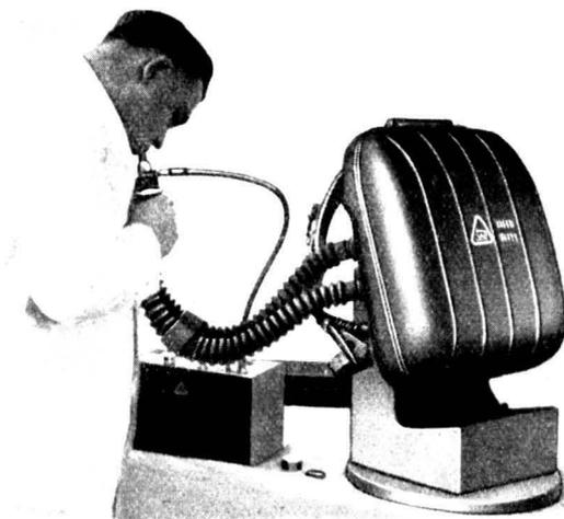
Bild 10. Zu Prüfvorgang 6: Prüfen des Heeresatmers auf Dichtigkeit.
