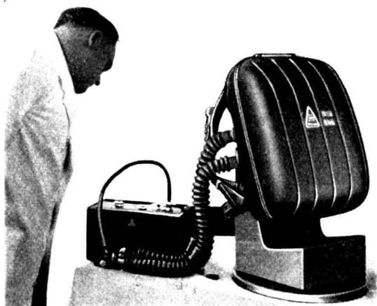
Bild 11. Zu Prüfvorgang 6: Ermitteln des Prüfergebnisses für die Dichtigkeit des Heeresatmers.
