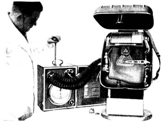
Bild 19. Zu Prüfungsvorgang 5: Handluftpumpe langsam betätigen.
