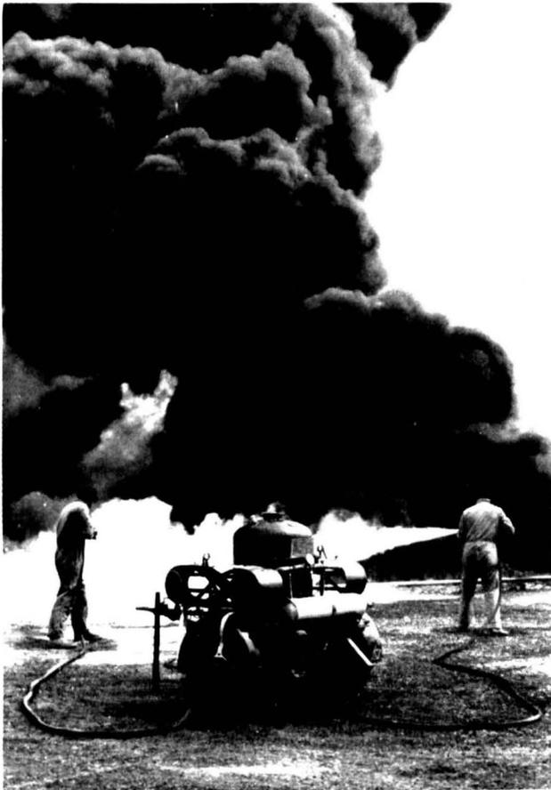
Abb. 12 Löschpulver-Anhänger (250 kg) im Einsatz
