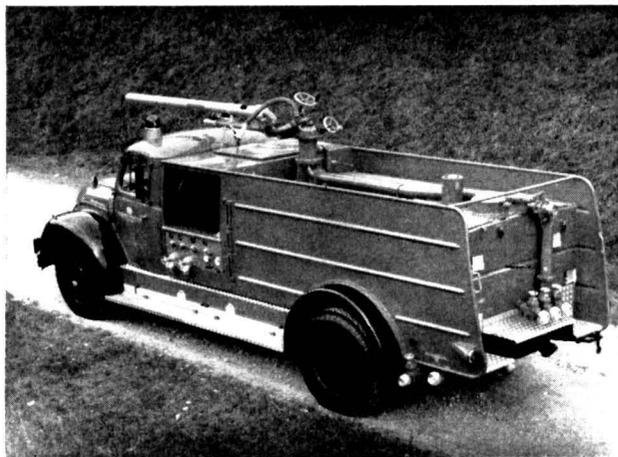
Abb. 8 Zumischer-Löschfahrzeug Tankinhalt 5000 l
