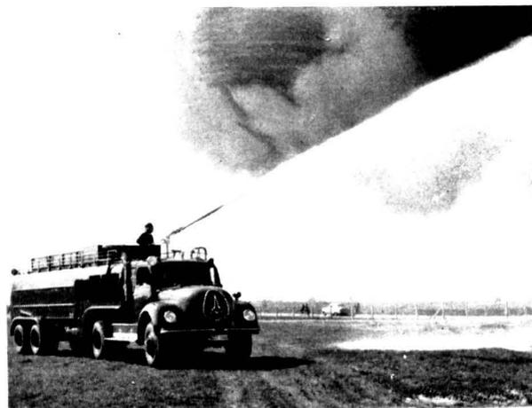
Abb. 11 Flugplatzlöschfahrzeug (Nachläufer)
