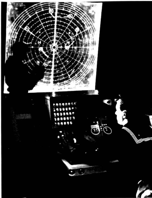
3) Die herkömmliche, zeitraubende Methode des Absteckens der jeweiligen Position von Feindobjekten im benachbarten See- und Luftraum (Hintergrund) auf der Gefechtsstafel wird durch das NTDS-Verfahren ersetzt, das in Verbindung mit der FRESCAN-Methode gleichzeitig Luft-Über- und Unterwasserziele erfaßt und in graphischen Zeichen darstellt (Vordergrund). (Bilder: USIS)
