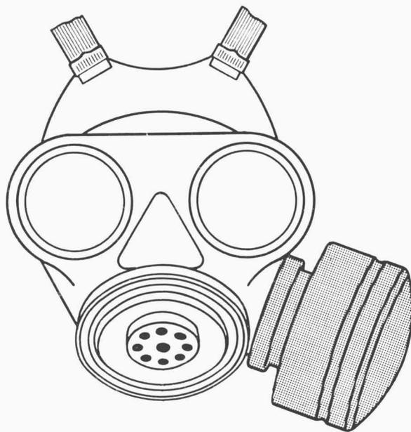
Abb. 11 Maske mit seitlichem Filtereinsatz
