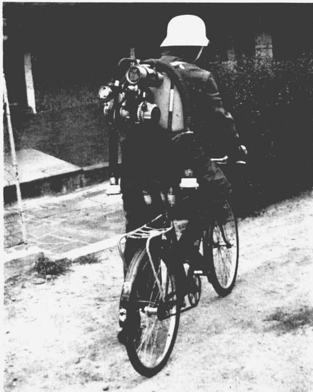
Bild 6 TS 0,5 mit Saugschlauch auf einem improvisierten Rücken-Tragegestell für Rad- und Motorradfahrer.
