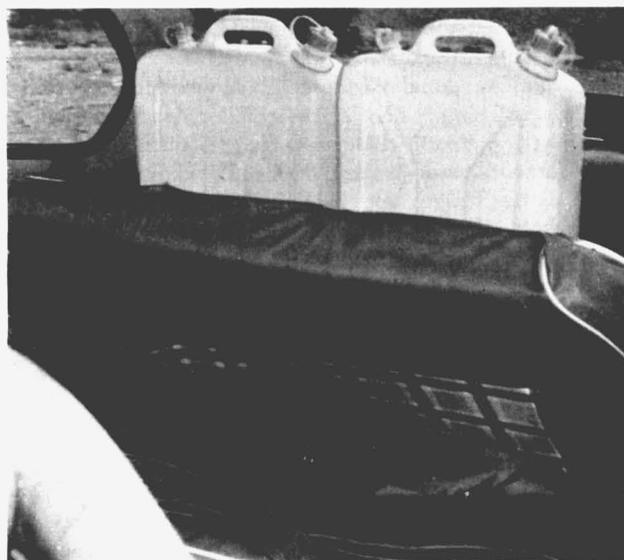
Bild 5 Wasserkanister im rückwärtigen Kofferraum eines Heckmotorwagens Fiat 600. Solche Kofferräume sind bei mehreren Kleinwagenmodellen anzutreffen.
