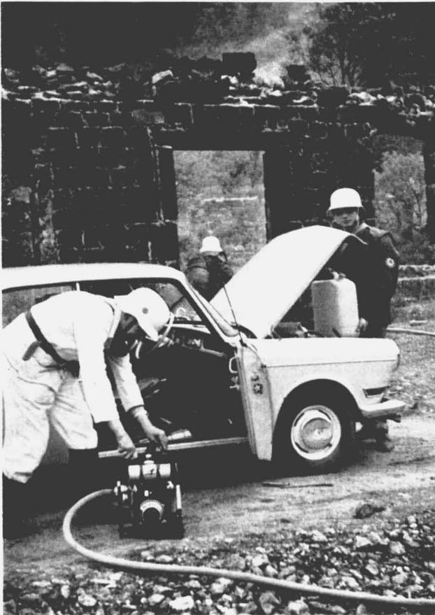
Bild 2 In wenigen Sekunden kann der Trupp den Brand angreifen. Hier saugt die TS 0,5 noch aus dem Flexi-Tank. Weitere Plastik-Kanister sind unter der Vorderhaube des Wagens.
