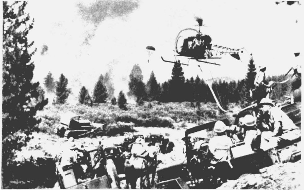
Abb. 4: Ausziehen einer Schlauchleitung durch Hubschrauber bei einem Waldbrand in USA. Die Feuerwehrmänner am Boden lösen sorgfältig den Schlauch von der Haspel, während andere Funkverbindung mit dem Piloten halten. Werksfoto Bell Helicopters.
