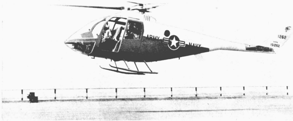
Abb. 15: Lockheed Hubschrauber mit Starr-Rotor im Probeflug. Wie die Aufschriften zeigen, wird die Entwicklung gemeinsam von der US-Army und Navy finanziert. Werksfoto Lockheed.
