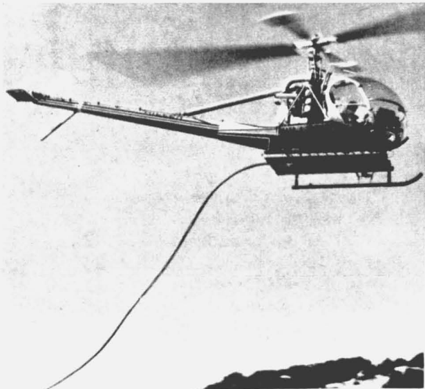
Abb. 5: Eine andere Methode der Schlauchverlegung aus der Luft bei einem Waldbrand in USA. Hier ist der Schlauch in Buchten in einem Kasten unter dem Rumpf untergebracht. Werksfoto Hiller.
