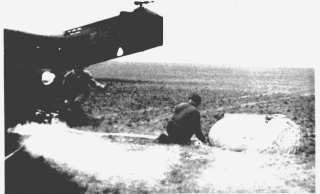
Abb. 10: Nach der Landung des Hubschraubers bringt die Löschmannschaft die TS 2/5 in Stellung und entwickelt den Löschangriff. Foto: Weiler, Mayen
