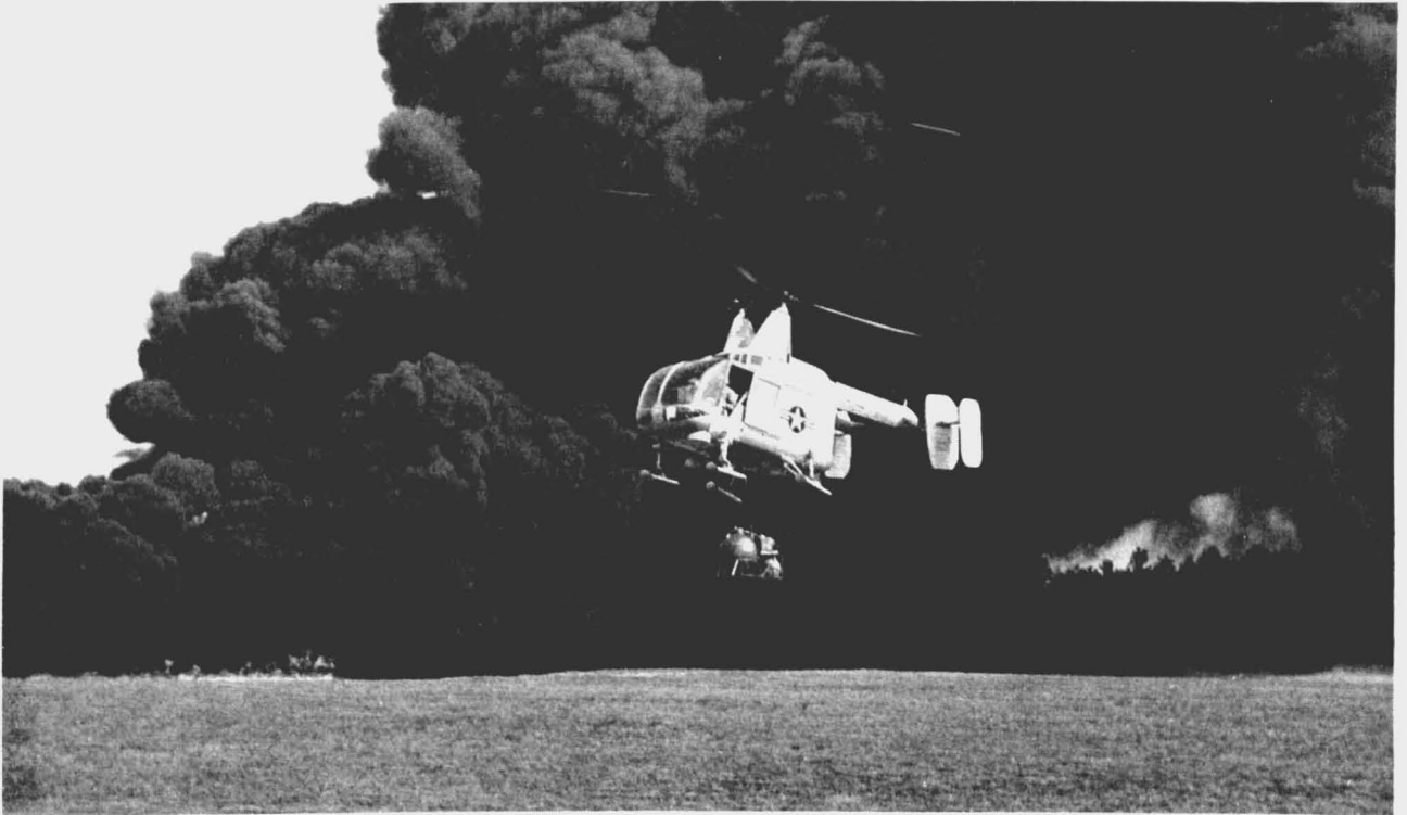
Abb. 2: Kaman Huskie Rettungshubschrauber der US Air Force fliegt mit Schaumlöschgerät am Lasthaken einen Brand an. Werksfoto Kaman.
