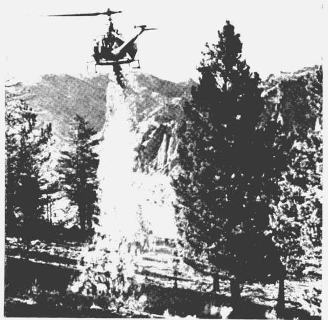
Abb. 6: Absprühen von Löschflüssigkeit gegen einen Entstehungsbrand, hier bei einer Vorführung in USA. Werksfoto Hiller.
