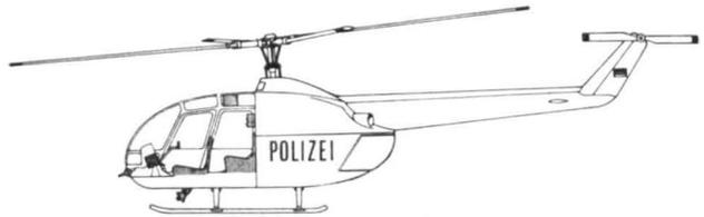
Für den Einsatz im POLIZEIDIENST kann der Hubschrauber mit allen notwendigen Geräten ausgerüstet werden. Eine schwenkbare Fernsehkamera läßt sich vor dem Beobachtungssitz einbauen. Zwei Krankentragen werden zusammengeklappt mitgeführt. Zum Transport von Verletzten kann die rückwärtige Sitzbank hochgeklappt werden.
