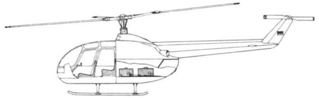
Die REISEAUSFÜHRUNG des Hubschraubers BO 105 ist vorne mit zwei Einzelsitzen, rückwärts mit einer durchgehenden Sitzbank ausgestattet. Pilot und vier Personen haben bequem Platz und nach allen Seiten ausgezeichnete Sicht. Das Gepäck wird im Lastenraum, der von außen zugänglich ist, untergebracht.
