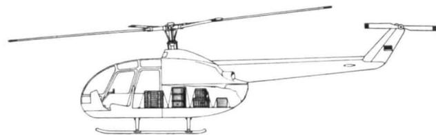
Zum LASTENTRANSPORT wird die Sitzbank hochgeklappt oder entfernt, so daß der gesamte Raum für das Ladegut zur Verfügung steht. Beladen wird durch die große Hecktüre, die beim Transport überlanger Teile während des Fluges offenbleiben kann. Besonders sperrige Güter können am Lastenhaken unter dem Rumpf transportiert werden.
