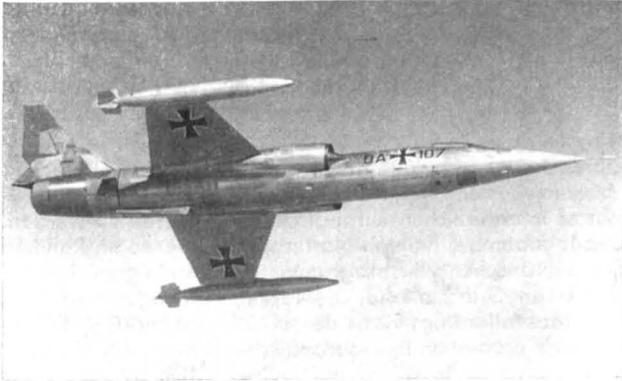
Abb. 4: Rückgrat der Jagdbombenverbände der Bundesrepublik wie auch mehrerer anderer NATO-Mitgliedstaaten sind die F-104 G „Starfighter“. Der Rumpf hat keinen Bombenschacht. Er bietet nur Platz für die 2 cm-Kanone. Bomben und Raketen werden außen angehängt.
