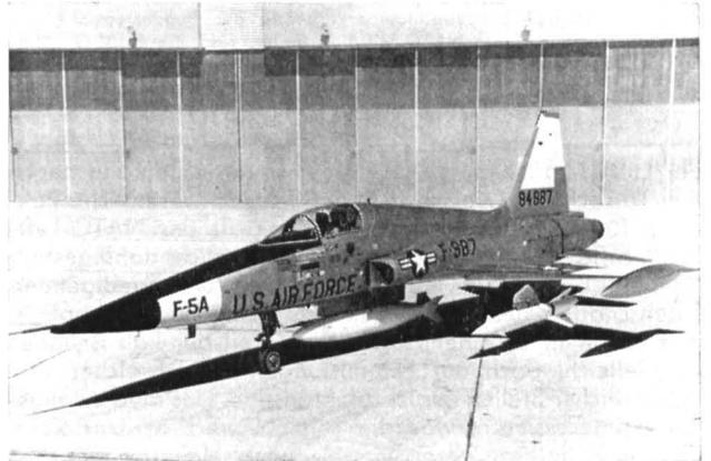
Abb. 7: Ein neues Jagdbombermuster in Europa ist die amerikanische Northrop F-5, hier mit dem Lenkflugkörper „Bullpup“ an den Tragflächen und Zusatztanks an den Tragflächenspitzen sowie unter dem Rumpf.
