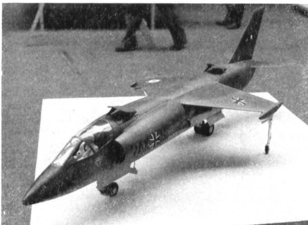
Abb. 11: Das ist das naturgetreue Modell des künftigen senkrechtstartenden leichten Jagdbombers der deutschen Luftwaffe VAK 191 B, der von deutschen, italienischen und englischen Werken gemeinsam gebaut wird. Neben dem Schwenkdüsentriebwerk hat die Maschine im Rumpf zwei Hubtriebwerke (unter den erkennbaren Abdeckklappen).
