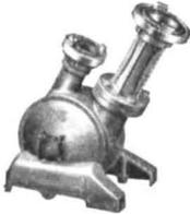
Die drehbare AWG-Wasserstrahlpumpe ist besonders strömungsgünstig ausgeführt und zeichnet sich durch hohe Leistung aus. Durch das verstellbare Gehäuse kann der Zu- und Abgang jeweils in die günstigste Betriebsstellung gebracht und die Wasserförderung nach jeder beliebigen Richtung eingeleitet werden. Die beiden Seitenschilde garantieren außerdem eine große Standfestigkeit.
