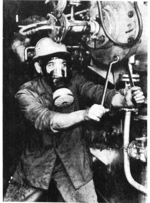
Dichtrahmens dicht und druckfrei. Durch die vollendete Konstruktion ist die neue Maske angenehm für den Träger, auch bei ständigem Tragen.
