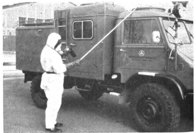
**Abb. 8:** Abspüren des verstrahlten Lastkraftwagens mit Hilfe einer zusammensetzbaren und auswechselbaren Stocksonde. Schwer zugängliche Meßpunkte können auf diese Weise erreicht werden.
