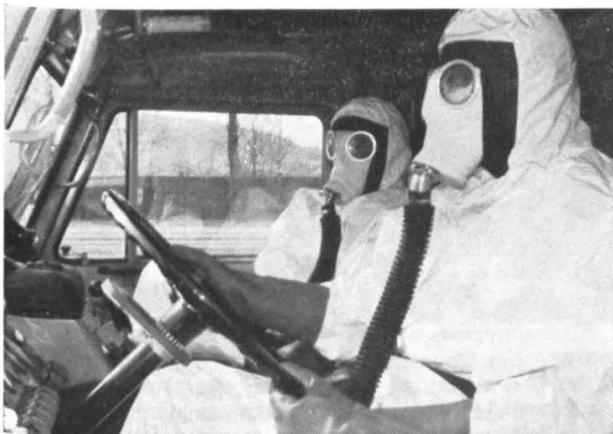
Abb. 4: Schutzluftanschluß im Fahrerhaus des ABC-Vorausfahrzeugs. Ein Einsatz unter schwersten ABC-Bedingungen ist dadurch gewährleistet.
