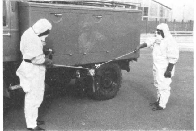
Abb. 5: Einsatz als Strahlenschutz- und Isotopenbergungsfahrzeug. Mit Ferngreifer und Stockmeßsonde wird hier ein festes radioaktives Präparat in einem Bleibehälter geborgen.
