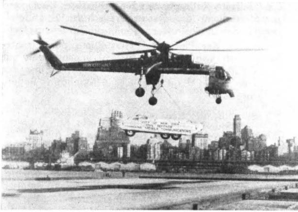
Hubschrauber sind in New York keine Seltenheit. Doch der „Fliegende Kran“ Sikorsky S 64 erregte während der Übung stets großes Aufsehen, wenn er sperrige Außenlasten heranschleppte, so hier ein Amphibienfahrzeug der Nachrichtenverbände der Zivilverteidigung.
