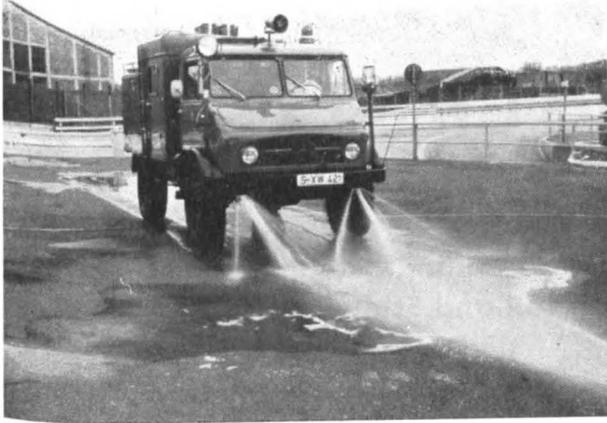
Abb. 10: Flächendekontamination eines verstrahlten oder vergifteten Einsatzplatzes mit Hilfe der eingebauten, druckluftgesteuerten Spritzanlage. Durch mehrmaliges Waschen mit scharfem Wasserstrahl wird eine gute Behelfsdekontamination erreicht.
