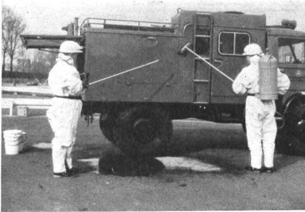
**Abb. 6:** Einsatz der Drucklufttragespritze mit angeschlossenen Waschbesen zur Dekontamination eines verstrahlten Fahrzeugs. Der Fortgang der Entstrahlung wird laufend mit Hilfe einer Stocksonde überwacht.
