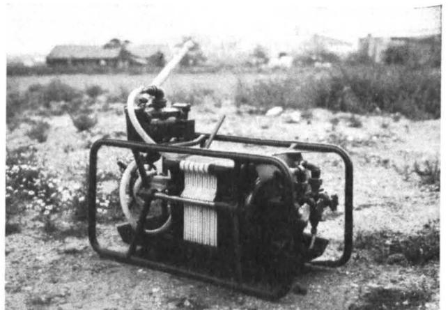
Bild 13: Schichtenfilter des neuen verlastbaren Trinkwasserfiltergerätes von Seitz mit 1000 bis 2000 l/h Leistung, für Beschickung durch Motorpumpe, mit aufgesetzter Reserve-Handpumpe.
