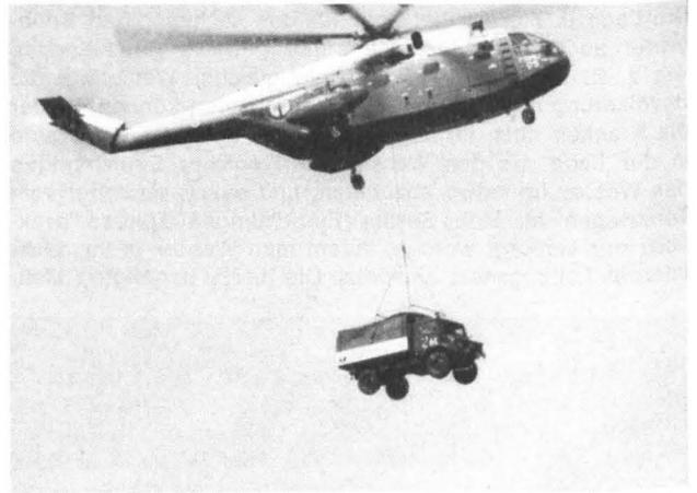
Bild 7: Lufttransport wird bei Berkefeld großgeschrieben. Hier fliegt ein französischer Hubschrauber Sud Aviation „Superfrelon“ den UNIMOG-S des Wasseraufbereitungszuges mit 3,6 t Gesamtgewicht mit Hilfe eines mitlieferbaren Heißgeschirrs am Lasthaken.
