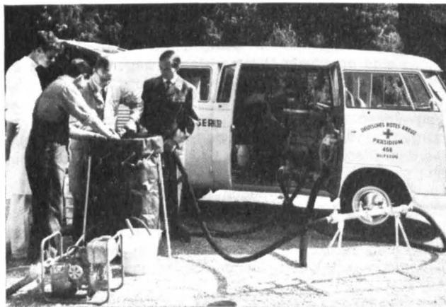
Bild 4: Selbstfahrendes Trinkwasser-Aufbereitungsgerät des DRK-Hilfszuges mit 4 000 l Stundenleistung, davor ein faltbares Vorklärbecken. In Florenz waren 8 dieser Wagen im Einsatz.
