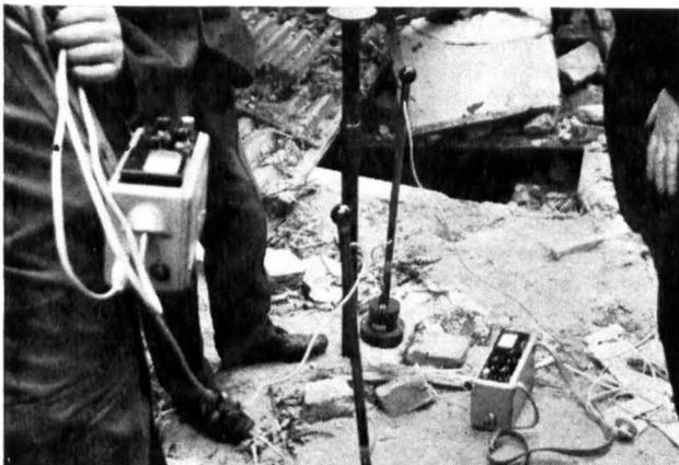
Abb. 5: Elektronisches Ortungsgerät.
