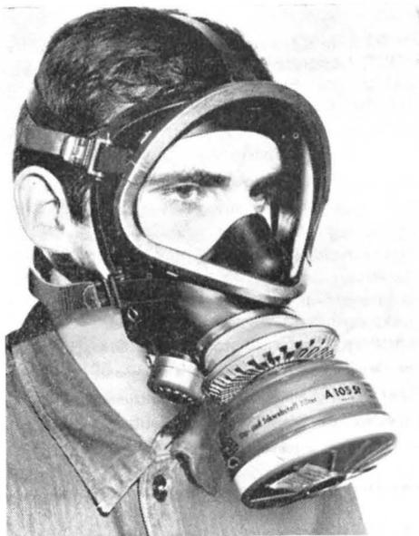
Der Buchstabe „S“ bedeutet, daß die Maske mit einer Sprechmembran versehen ist. Diese Membran liegt ringförmig unmittelbar vor dem Mund; da sich in der Mitte der Membranfläche der Rundgewindeanschluß befindet, beansprucht sie keinen zusätzlichen Platz. Die Stimme des Maskenträgers ist gut und lautstark verständlich, auch über Telefon, Megafon oder Sprechfunk.
