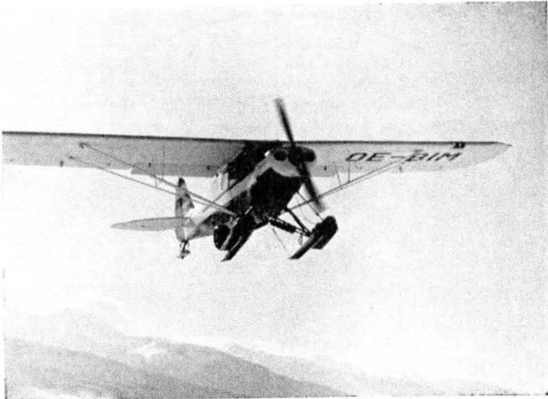
Durch die Verwendung von Starrflächenflugzeugen konnte der Flugdienst des österreichischen Bundesministeriums mit relativ geringen Mitteln zu großer Leistungsfähigkeit gebracht werden. Die Leichtflugzeuge PA-18 „Piper-Cub“ sind mit hydraulisch ausfahrbaren Schneekufen ausgerüstet.
