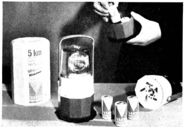
Die VARTA Warnblinkleuchte bietet durch den eingebauten volltransistorisierten Blinkgeber ohne bewegliche Kontakte einen besonders störungsfreien Betrieb bei geringstem Stromverbrauch. Gegenüber den bisher üblichen Thermoblinkern wurde außerdem eine erheblich längere Lebensdauer erreicht, und die Blinkfrequenz ist von der Außentemperatur unabhängig geworden.
