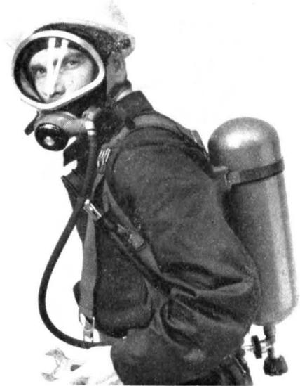
Seine hervorragende Isoliereigenschaft schützt vor der Expansionskälte der Preßluftflasche.
