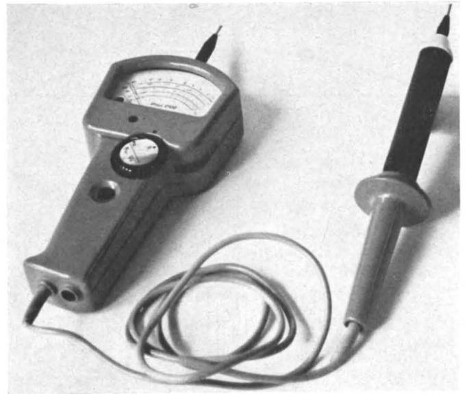
**Bild 2: Meßgerät zur Feststellung des Netzschleifenwiderstandes.**
