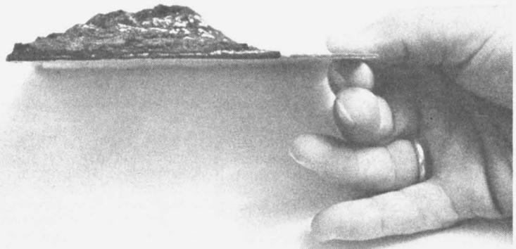
**So wirken Brandschutz-Anstrichsysteme. Die Dämmschichtbildner entwickeln aus einem rund 1 mm dicken Anstrich einen dichten Schaum von rund 40 mm Dicke, dessen Wärmeleitfähigkeit etwa tausendmal geringer ist als die von Eisen. (Foto: DLI)**
