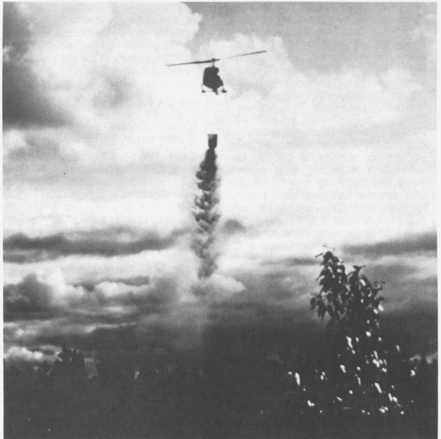
**Bild 5** Bei den Waldbränden in Niedersachsen wurden erstmals in der BRD auch Flugzeuge zur Brandbekämpfung eingesetzt. Hier ein Hubschrauber mit einem Spezialbehälter aus ADIPRENE mit 3400 Liter Inhalt.
