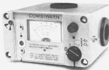
Das automatisch arbeitende, tragbare „Combiwarn“ vereinfacht somit die Luftüberwachung. Die Skala zeigt die Gaskonzentration im Bereich 0 bis 50 % der unteren Explosionsgrenze oder – nach Betätigung eines Schalters – die Sauerstoffkonzentration zwischen 0 und 25 Vol.-% an. Die Alarmschwellen sind einstellbar. Blinksignal sowie unterbrochener Heulton lösen die Warnung aus, wenn die eingestellte Alarmschwelle überschritten wurde.
