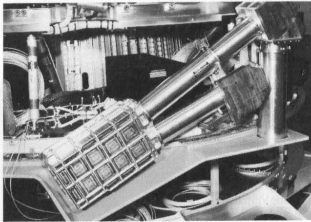
Abb. 5 Sensor und Elektronikbox auf dem Vibrator (Strukturmodell)
