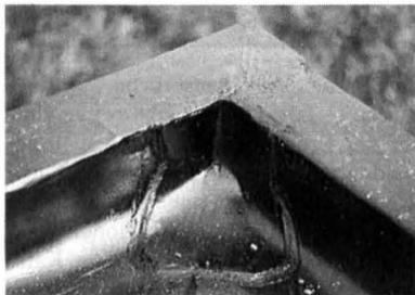
Basis für diese Eigenschaften: der Aufbau der Bahn mit alterungsbeständigem Polyolefin Copolymer, Spezial-Bitumen als Deckschicht und zwei thermisch endverfestigten Polyestervlies-Einlagen in Stärken von 200 bzw. 150 g/m<sup>2</sup>.
