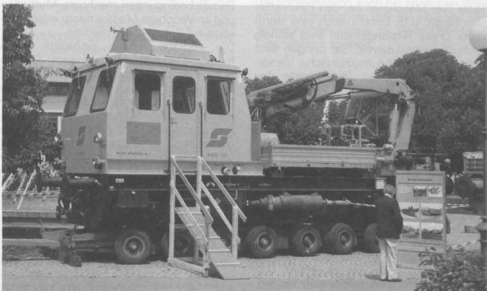
Motorbahnwagen dieses Typs werden in Österreich zur Tunnelrettung eingesetzt
