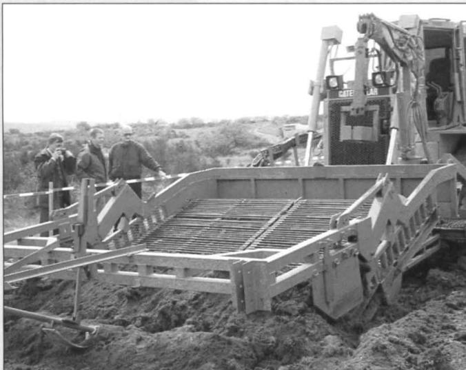
Durch dieses Verfahren wird erreicht, daß keine Minenteile im Gelände verbleiben, die weiterhin eine potentielle Gefahr darstellen. Ein
