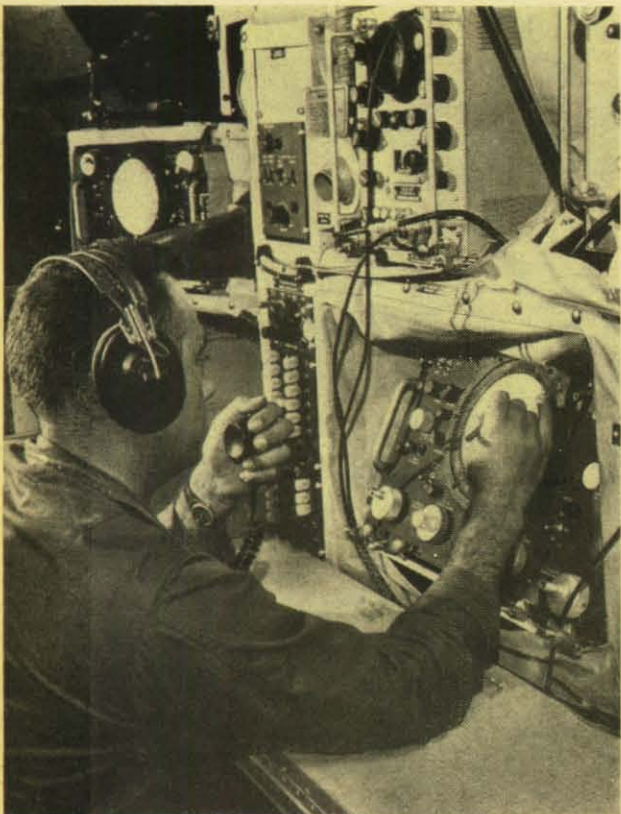
Der Radar-Bildschirm ist der Zauberspiegel des Kontrollsystems. Der Nachrichtenoffizier kann auf ihm genau die Bewegungen eigener und feindlicher Flugzeuge verfolgen, so daß er rechtzeitig Anweisungen für die Verteidigung von Flugzeugen, Truppen, Schiffen und Bodenstationen geben kann. Durch die fliegende Radar-Station werden auch ferngelenkte Geschosse schon so früh erkannt, daß im Zielgebiet eine kurze Warnzeit zum Schutz der Zivilbevölkerung möglich sein dürfte.
