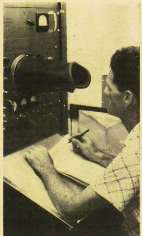
Auch eine Wetterstation befindet sich auf der künstlichen Insel im Meer, die 160 km von der Küste entfernt ist. Der Meteorologe trägt seine Beobachtungen in eine Tabelle ein. Der Radar-Bildschirm ist hier durch eine vorstehende Röhre gegen das einfallende Tageslicht geschützt. Auf diese Weise wird das Bild klarer. Eine genaue Ablesung, auf die es ja ankommt, wird so möglich.
