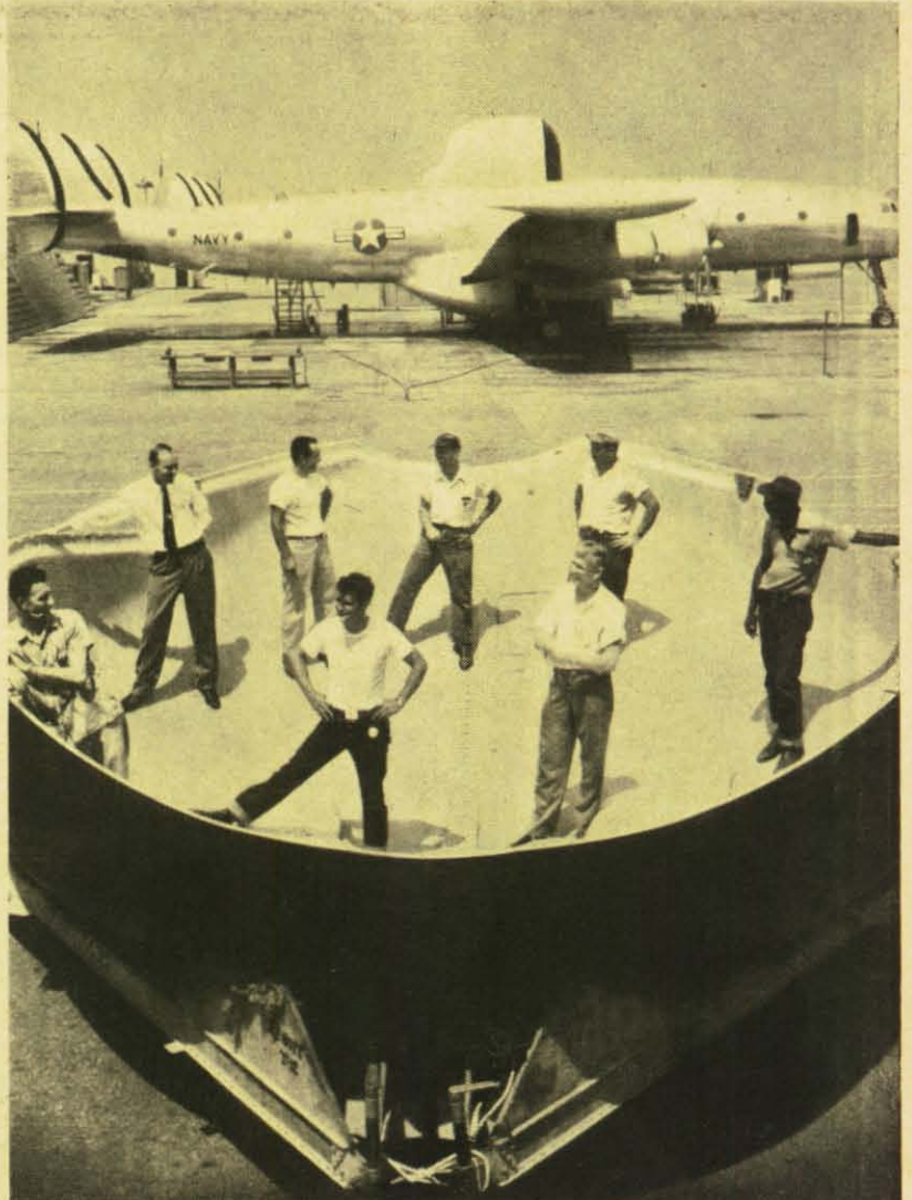
Den riesigen Känguruhbauch der mit Radar ausgerüsteten Super-Constellation zeigt dieses imposante Bild, das von der amerikanischen Marine freigegeben wurde. Es handelt sich bei diesem „Bauch“ um das Unterteil des Flugzeugs, in dem Peilungsgeräte im Gewicht von 6 Tonnen untergebracht werden können. Die militärische Bezeichnung der Super-Constellation ist: WV-2. Sie operiert als Frühwarnflugzeug.
