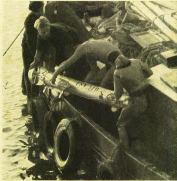
Mit großer Sorgfalt wird das Torpedo zum Wasser gelassen. Das neue Gerät ist 2,50 m lang und besitzt zwei Lampen mit wenig Volt und viel Ampère. An der Hinterseite wird das Torpedo gehandhabt. Hier betätigt man den Motor, die Lampen und alle Apparate. Im Innern befindet sich eine richtige elektrische Fabrik mit Batterien, die die Energien für den Motor und das Blitzgerät liefern.
