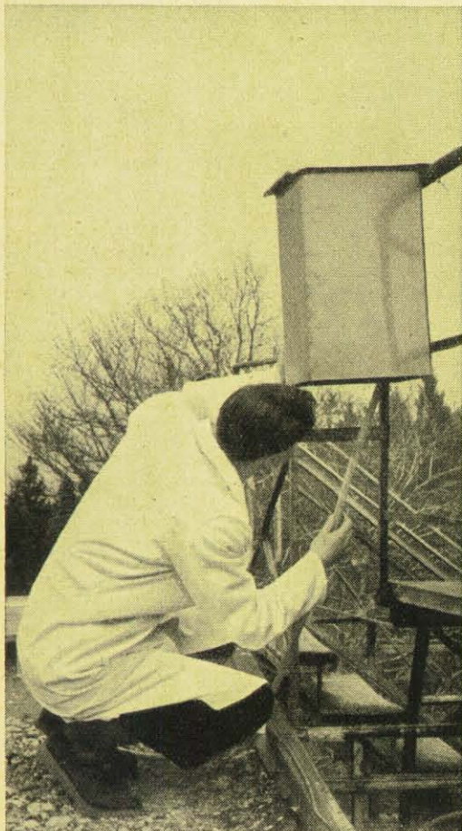
In diesen Blechkästen wird die Heidelberger Luft angesaugt und gefiltert. Alle 48 Stunden werden die Filter ausgewechselt. An der Beschaffenheit der Filter können die Fachleute des Observatoriums in Heidelberg feststellen, ob die aufgefangene radioaktive Substanz natürlichen Ursprungs ist oder etwa von einem Atombombenversuch herrührt. So können mit Sicherheit geheime Experimente mit A-Waffen ermittelt werden. Nur wo sie stattfanden, bleibt ungeklärt.
