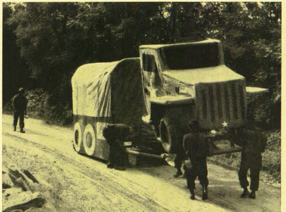
Aus zwei Teilen Gummi besteht dieser Lastwagen. Auf unserem Bild werden die beiden Teile gerade aneinander befestigt. Vier Mann können den gesamten „Lastzug“ transportieren. Die Täuschung ist aus der Vogelperspektive, zumal bei guter Tarnung, gar nicht erkennbar.
