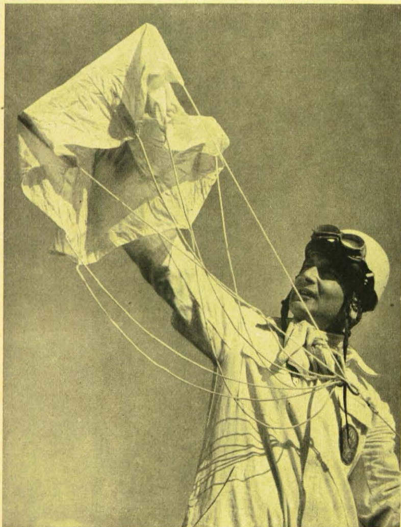
Zwei Arten von Fallschirmen unterscheidet man grundsätzlich: manuell ausgelöste und automatische Fallschirme. Beim manuellen Fallschirm zieht der Springer mit der Reißleine einen Hilsschirm aus der Verpackung, Durchmesser 40 cm. Der Luftwiderstand bringt dann den Fallschirm zur Öffnung. Dieser Vorgang dauert Luftbruchteile von Sekunden. Der automatische Fallschirm wird durch eine Leine ausgelöst, die am Flugzeug und am Sitz befestigt ist, und öffnet sich sofort, nachdem der wagemutige Springer aus seiner Maschine „ausgestiegen“ ist.
