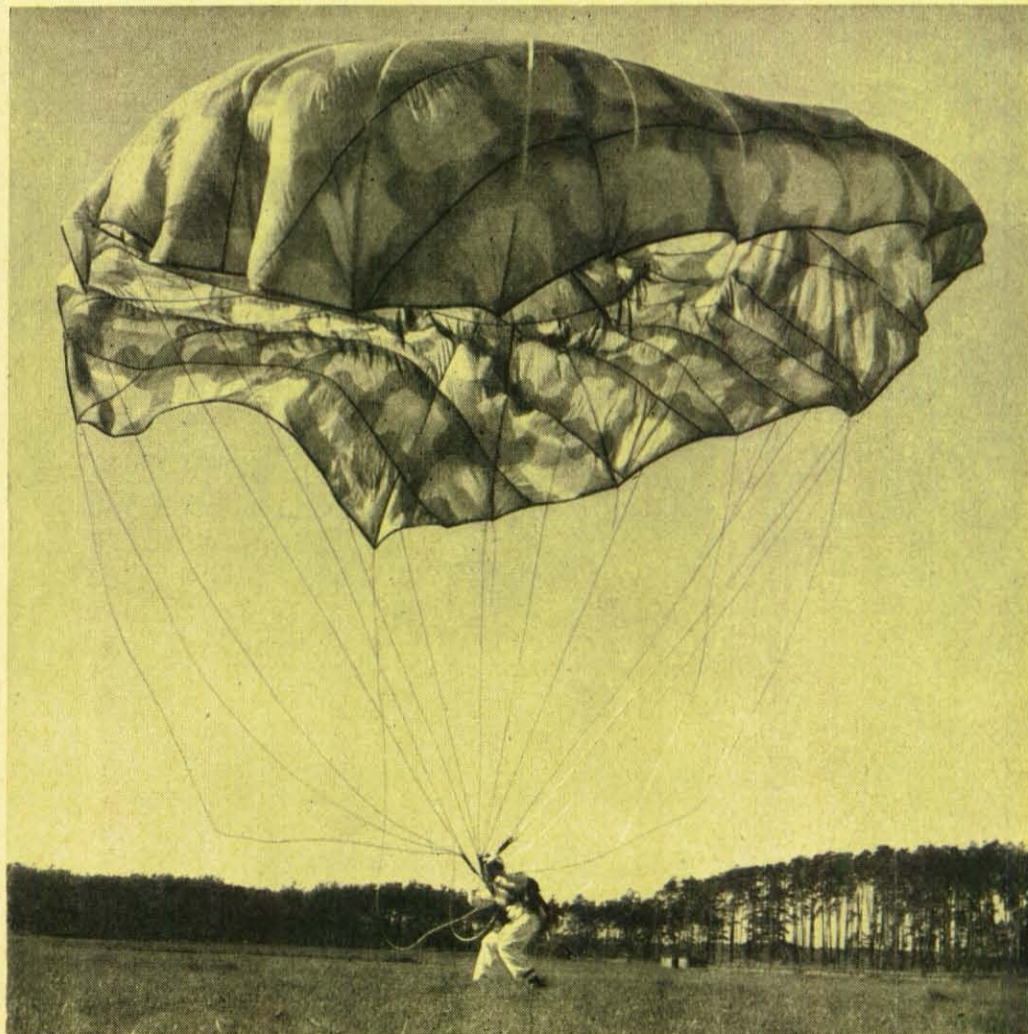
Die Sekunde der Bodenberührung ist in dieser Aufnahme präzise und anschaulich festgehalten. Weich ist das Auftreffen auf die Erde. Der neue Dreieckschirm verleiht dem Springer eine Fallgeschwindigkeit von 3—3,5 m/sec. Der Aufsprung entspricht einem Sprung aus 1,20 m Höhe. Beim Rundkappenschirm von früher wird eine Fallgeschwindigkeit von 6—7 m/sec erreicht. Der Aufsprung entspricht einer Höhe von 3,50 m. Dieser Schirm, Fallschirmspringen ist nicht nur eine Angelegenheit für kaltblütige und mutige Männer. Auch Frauen treiben diesen nicht alltäglichen Sport. Eine Frau, Odette Roussau aus Frankreich, ist sogar Inhaberin des Weltrekords für Fallschirmspringer.
