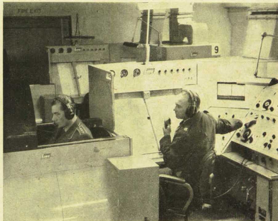
Fertig zum Start — in der Schulstube! Der Link-Trainer ist ein ideales Schulungsgerät mit einem komplizierten elektronischen Rechengehirn, das nicht nur mit seinen Instrumenten einer „echten“ Maschine originaltreu nachgebildet ist, sondern auch die „Flugeigenschaften“ eines Originalflugzeuges aufweist. Auf einem Schaltbrett kann der Lehrer (rechts) Gewitter und Windböen, Seiten- und Gegenwinde und alle unerwarteten Schwierigkeiten, die in Wirklichkeit auftreten können, einstellen und bewirken. Der Schüler muß versuchen, richtig zu reagieren.
