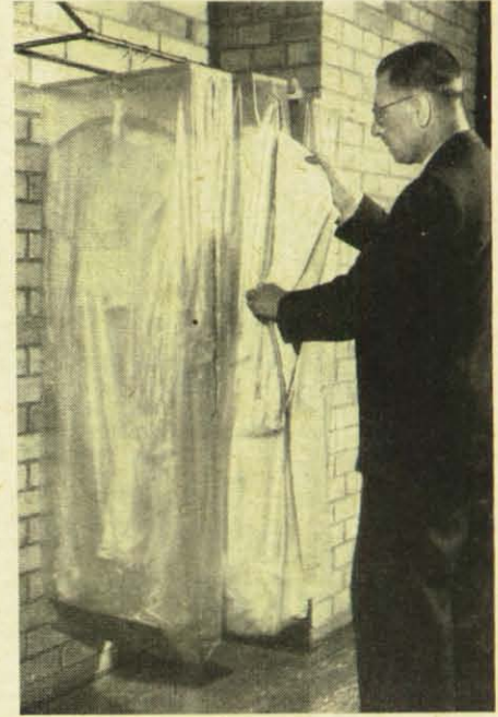
Nicht als Mottenschutz, sondern als eine Strahlenschutzmaßnahme dienen hier die Perlonhüllen, denen Prof. Langendorff gerade seinen Arbeitsmantel entnimmt. Man steckt die Arbeitskleidung in solche Hüllen, damit nicht in ihnen haftender radioaktiver Staub in die Luft der Räume gelangt und sie gesundheitsschädlich macht für die, die sie einatmen.
