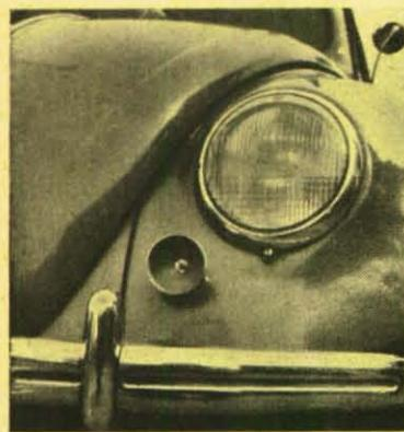
Das kleine Horn am Wagen ist ein Ultraschallheber. Es wird durch den Druck auf einen Knopf am Armaturenbrett betätigt. Die Wellen, die von ihm ausgehen, öffnen automatisch die Garagentür, und der Wagen kann einfahren.
