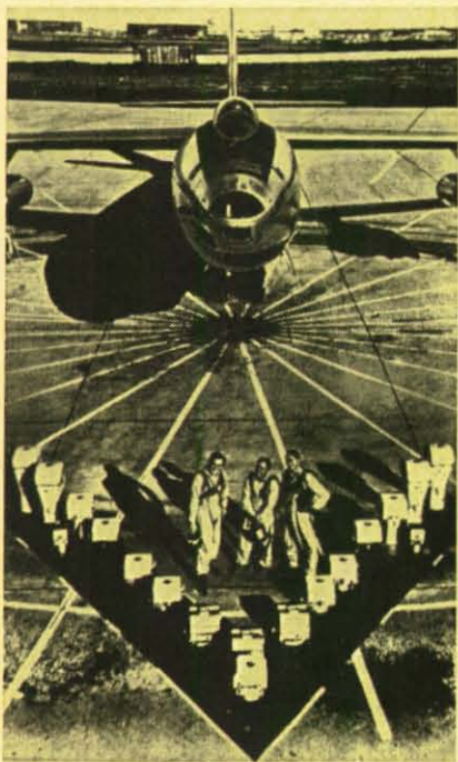
In 12 000 m Höhe wird aus diesem Fotoaufklärer Boeing RB-47 E der US-Luftwaffe fotografiert. Mit den 16 Spezialkameras (im Vordergrund sieben Reihenkameras) kann in drei Stunden eine Fläche von rund 2 590 000 Quadratmeter Größe aufgenommen werden. Die Maschine führt zahlreiche Leuchtpatronen und zehn Blitzlichtbomben für Nachtaufnahmen mit. Die Besatzung besteht aus zwei Piloten und einem Fotografiennavigator.
