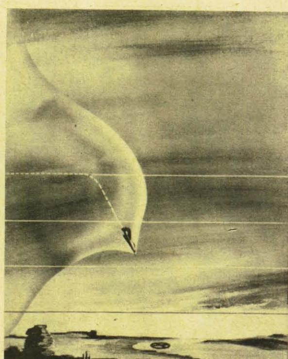
**Der typische Sturzflug** eines Düsenjägers, bei dem der Vorgang des Durchbruches der Schallmauer zum erstenmal wahrgenommen wurde. Dabei richtet sich die Spitze des Schallkegels zur Erde. Das donnerartige Getöse wird jedoch erst dort auf der Erde gehört, wo der äußere Rand des Kegels die Erde berührt. Würde sich das Flugzeug abfangen, so wäre auf der Erde nichts zu hören.
