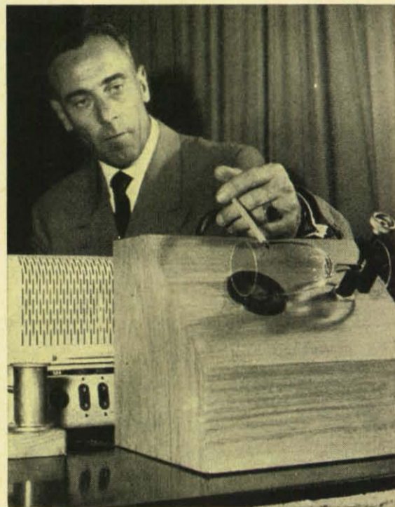
Sein Kollege schraubt das Glas inzwischen an einen Lautsprecher und hält einen Bleistift daran. Die Nadel des Plattenspielers schwankt in der Rille, der Tonabnehmer verwandelt die Schwankungen in Elektrizität, das Glas zittert, der Bleistift hüpfet unruhig auf und nieder.
