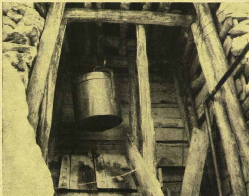
Eine vorsintflutliche Anlage bringt Gesteinsproben der gefundenen Ammoniumlager zutage. Ammonium (Pechblende) ist ein Salz, das unter Umständen bis zu 76 Prozent Uran enthält. Lohnt sich der Abbau, so wird eine moderne Förderanlage errichtet.
