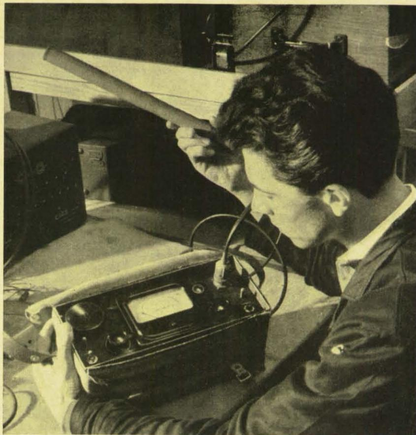
Die Wünschelrute des Atomzeitalters ist der Geigerzähler. Das von den Physikern Geiger und Müller 1928 entwickelte Zählrohr wird in zwei Arten von Geräten eingebaut. Die Suchgeräte ticken, wenn sie Stoffen mit radioaktiver Strahlung, z. B. Uran, näher kommen. Die Meßgeräte (unser Bild) zeigen auf einer Skala die Stärke der Radioaktivität an.
