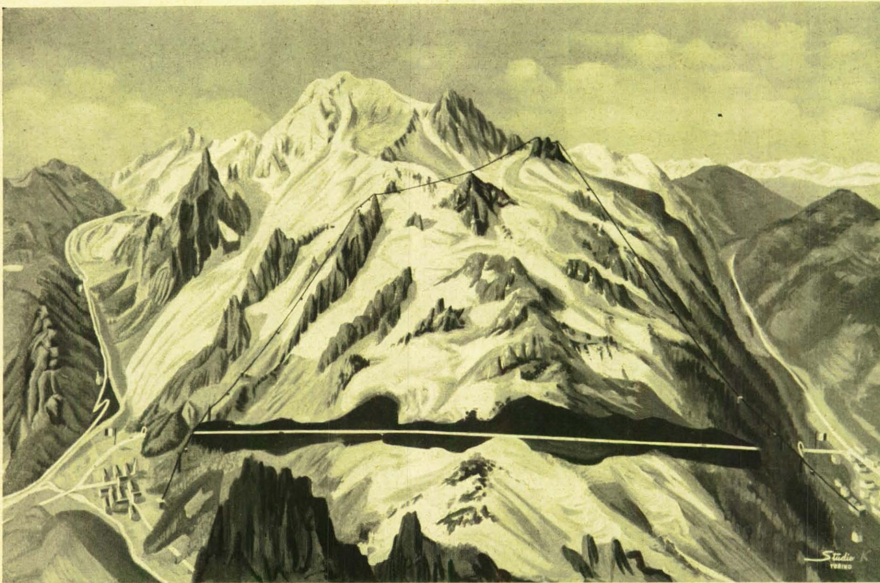
**Neue Verkehrsverbindungen** führen nach den Plänen des italienischen Ingenieurs Totino über und durch den Montblanc. Der Tunnel wird ungefähr 12 Kilometer lang, seine Straße über 7 m breit und 6 m hoch. Seilbahnen reichen von der italienischen und der französischen Seite schon zur Höhe. Nun wird das mittlere Verbindungsstück erbaut, das diese gigantische Bergwelt erschließt.
