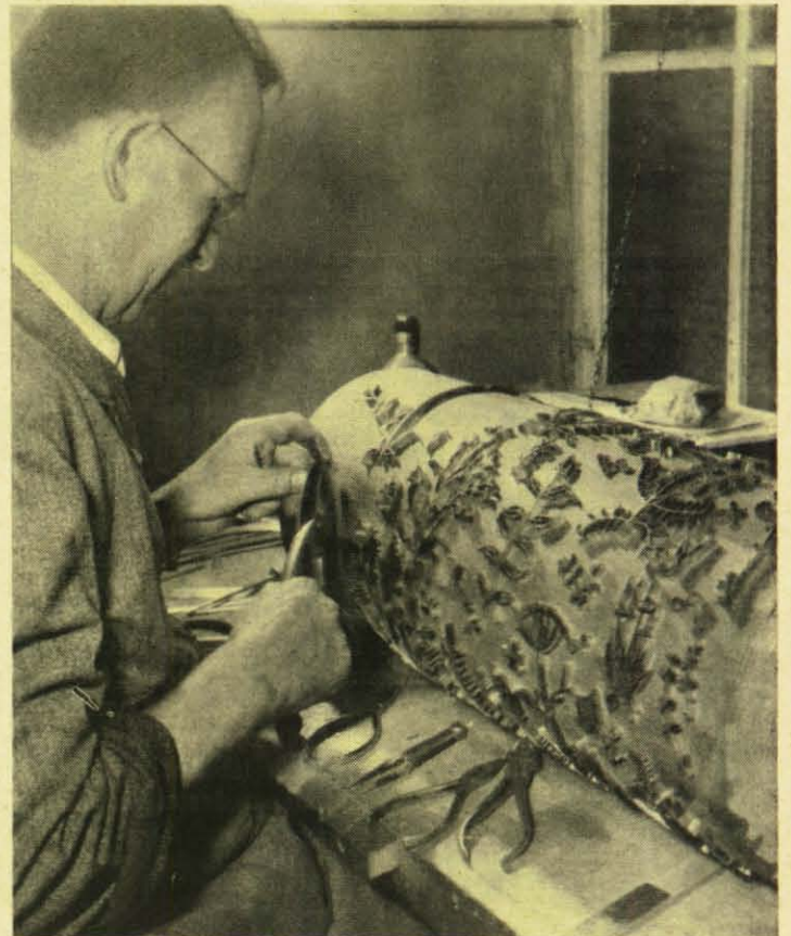
Der Formstecher bei der Arbeit. Aus Messingdraht fertigt er ein Tapetenmuster an. Feinstes Formempfinden, saubere Arbeit und handwerkliche Geschicklichkeit sind Voraussetzung für diesen künstlerischen Beruf. Eine solche Walze herzustellen dauert manchmal länger als sechs Wochen.
