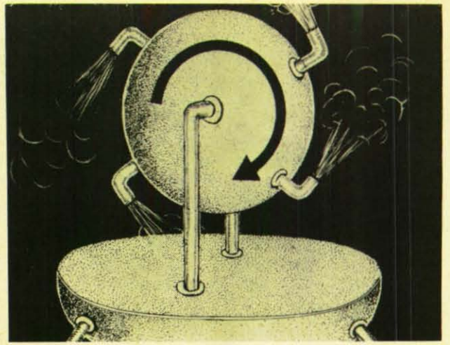
II Dieser Heronsball ist die allererste Dampfmaschine
