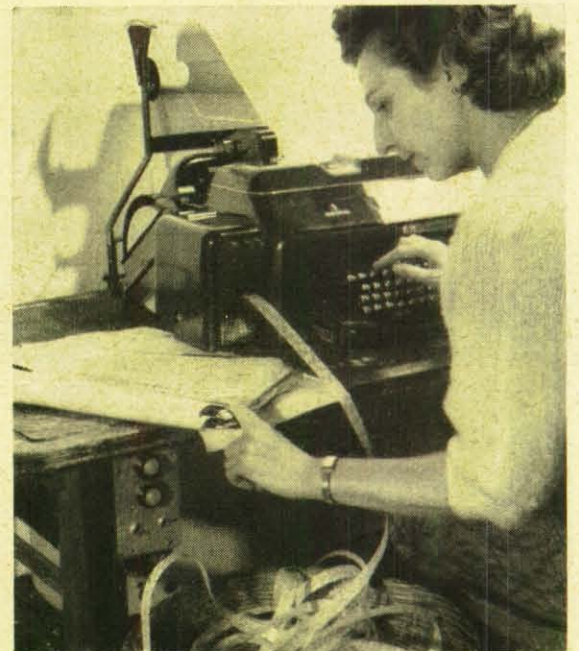
Die Befehle werden mit einer Spezialschreibmaschine auf Lochstreifen geschrieben. Der Roboter kann einige hundert Aufgaben in der Sekunde lösen. Die Art und die Reihenfolge wird vorher festgelegt und dann von einem sogenannten Befehlsspeicher aus völlig automatisch gesteuert.
