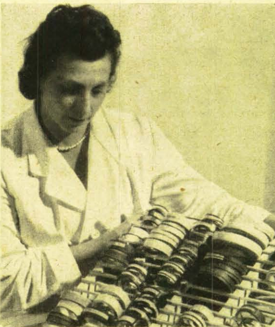
Die „Programmbibliothek“. Für ständig wiederkehrende Aufgaben werden im Rechenzentrum Lösungsvorschriften auf Lochstreifen zum sofortigen und schnellen Einsatz bereitgehalten. Bei komplizierten Aufgaben lassen sich die einzelnen Bibliotheksprogramme zusammensetzen.
