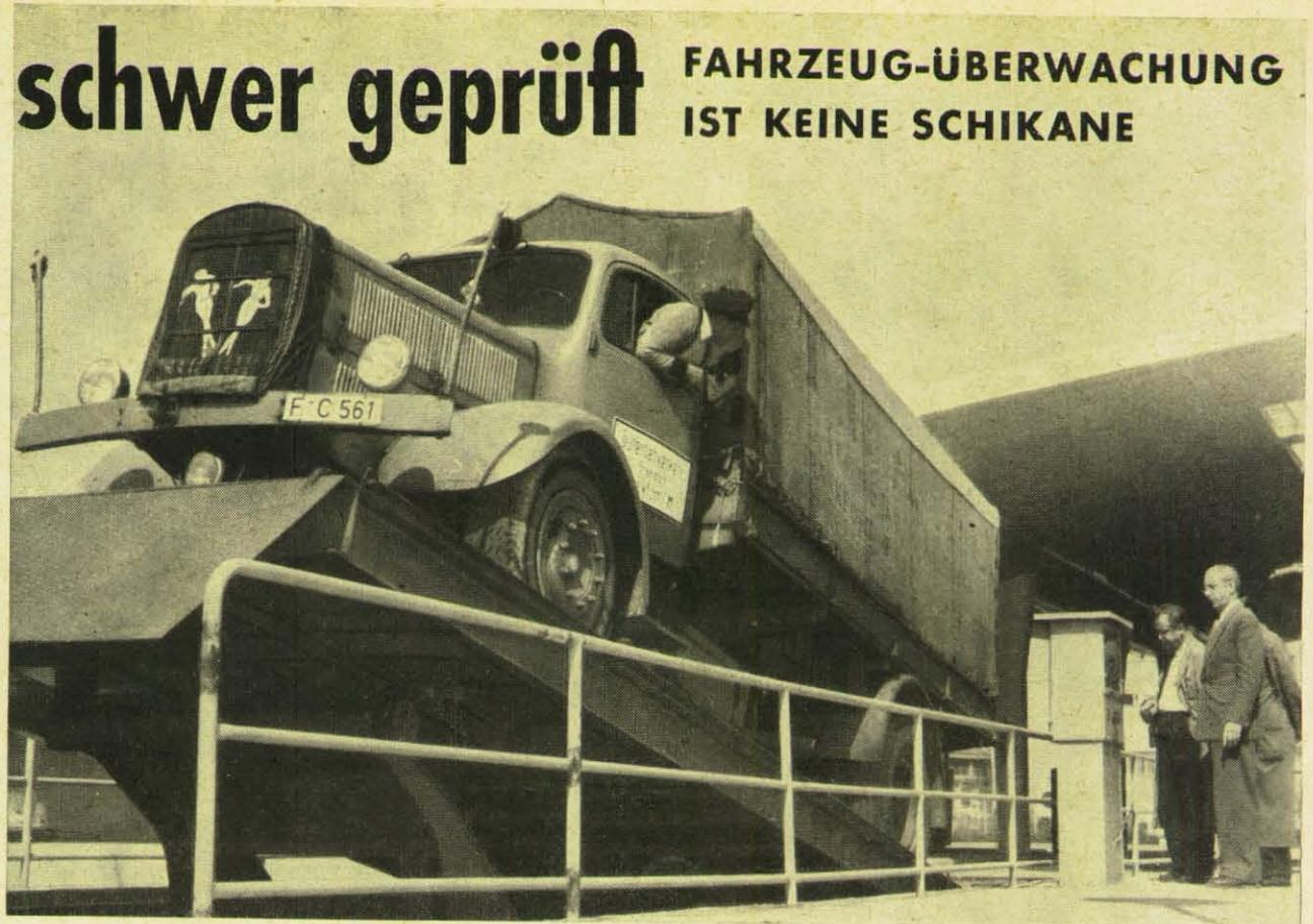
Ihre „Bergprüfung“ müssen die Fahrzeuge auf einer kippbaren Plattform bestehen. Dabei wird festgestellt, ob die Handbremse dem Fahrzeug beim Halten am Berg einen absolut sicheren Stand verleiht. Die Plattform kann übrigens in einen „Berghang“ mit einer Steigung von 35% verwandelt werden. Ein Wagen, der solche Prüfungen besteht, wird seinen Fahrer selbst in den Alpen nicht im Stich lassen.
