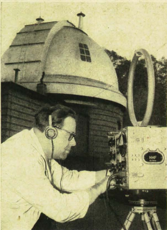
An einem Feldstärkemeßgerät wurde von der Radio- sternwarte der Universität Bonn die Erdumkreisung des „Sputnik“ verfolgt. Die Sowjetunion will schon bald Raketen mit Menschen ins Weltall schicken. Zwischen 1960 und 1965 sollen sie den Trabanten unserer Erde, den Mond, erobern.
