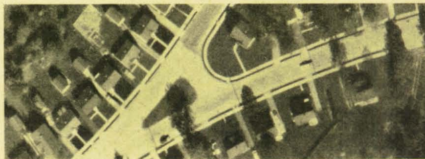
Mit Blitzlicht und Infrarot schießen die Kameras des Fernaufklärers bei Nacht und Nebel Bilder von fast der gleichen Präzision wie bei bester Tagesbeleuchtung. Das obere Bild zeigt die Tagesaufnahme einer Straßengabelung, das untere dasselbe Objekt bei Nacht.
