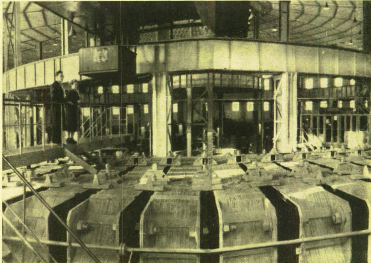
Westlichen Journalisten zeigte der italienische Physiker Bruno Pontecorvo, der mit wichtigen Geheimnissen nach dem Kriege aus England in die Sowjetunion geflohen war, das Synchro-Zyklotron, einen zweiten Beschleuniger in Dubna. Er wurde von den Kiro-Werken in Leningrad hergestellt und erzeugt „nur“ 680 Millionen Elektronenvolt. Die Dimensionen seines Magneten messen 18×10×7 Meter. Bereits 1946 betrug der Wert der Forschungsanlagen in Dubna 500 Millionen Rubel. Er stieg beträchtlich an.
