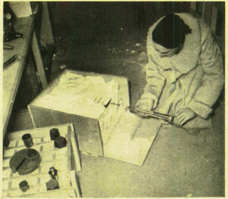
Im Kältelaboratorium werden immer wieder Versuche zur Festigung des Schnees unter sehr unterschiedlichen Belastungen angestellt. Der Schnee wird in Kisten gestampft und unter verschieden schwerem Druck ständig beobachtet. Die Fotos rechts zeigen zwei Schneekristalle.
