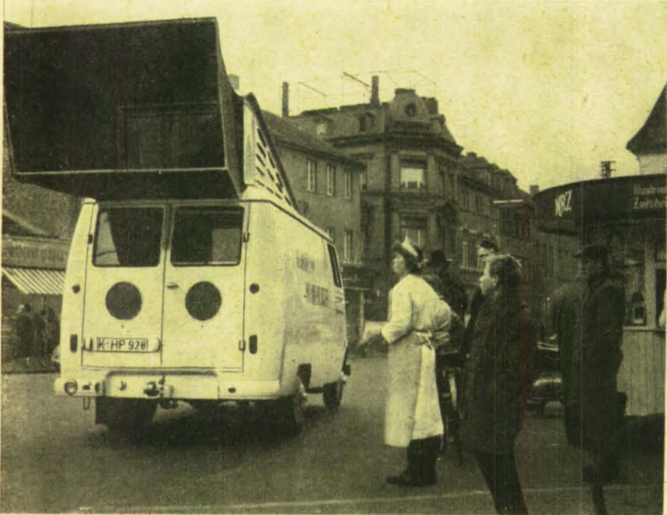
Man sieht es ihm äußerlich nicht an, was der neue Film- und Werbewagen an technischen Spezialeinrichtungen in sich birgt. Sein Dach kann in der Mitte der Längsrichtung nach oben hochgeklappt werden. In einem aufsetzbaren schwarzen Tuchgehäuse befindet sich eine Mattscheibe, auf die vom Wageninnern Filme projiziert und auch bei hellstem Tageslicht gut gesehen werden können.
