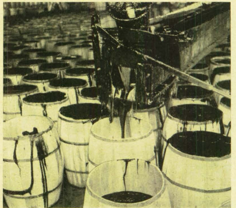
Die zähflüssige Masse, der nach verschiedenen Reinheitsgraden raffinierte Asphalt, wird in die Fässer abgefüllt, um per Schiff in alle Welt verschickt zu werden. Der See hat eine Oberflächenausdehnung von ungefähr einem halben Quadratkilometer und eine Tiefe von etwa 80 Metern. Seit nahezu sechzig Jahren wird das Material kommerziell ausgenutzt.
