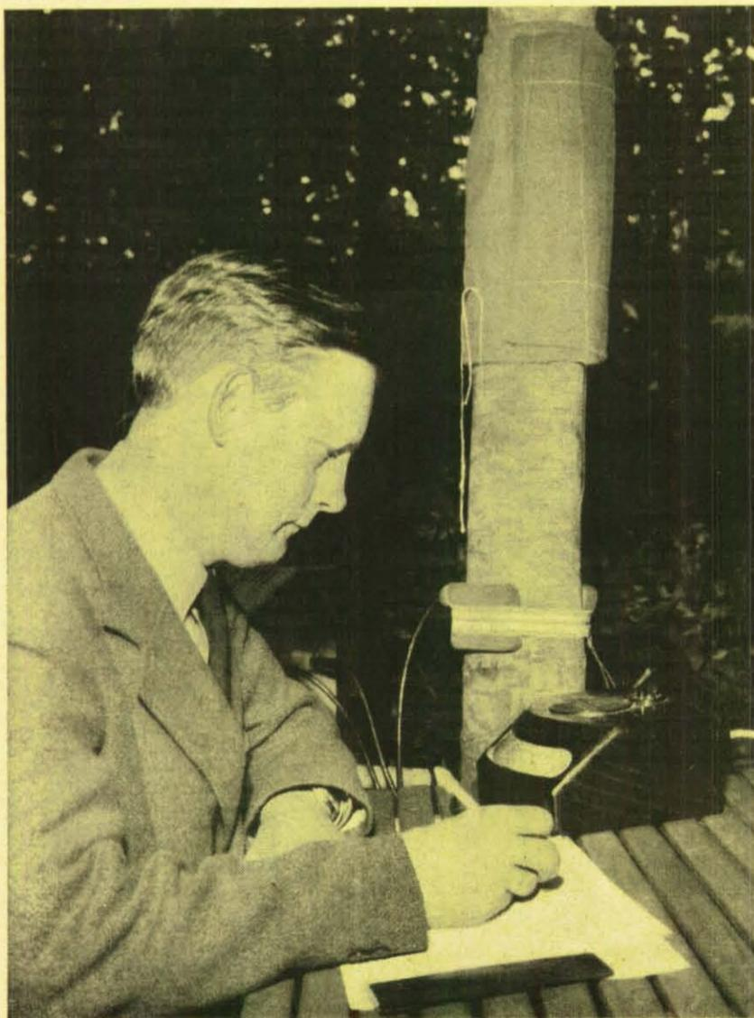
Der Oberförster Dr. Ladefoget kontrolliert Versuche mit einem Diathermie-Apparat, wie sie auch in Deutschland gemacht wurden. Man kann auf diese Weise feststellen, in welcher Zeit ein Baum eine bestimmte Menge erwärmten Wassers aufnimmt. Diese Experimente erwiesen sich jedoch bald als ungenau, und man ging zu einer anderen Methode über.
