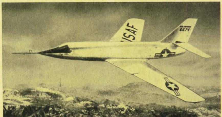
Die Douglas Skyrocket ist das Gegenstück der US-Marineluftwaffe zur Bell X-1. Sie erflieg unter dem Ingenieur-Piloten Bill Bridgeman die Rekordhöhe von 25 387 m.
