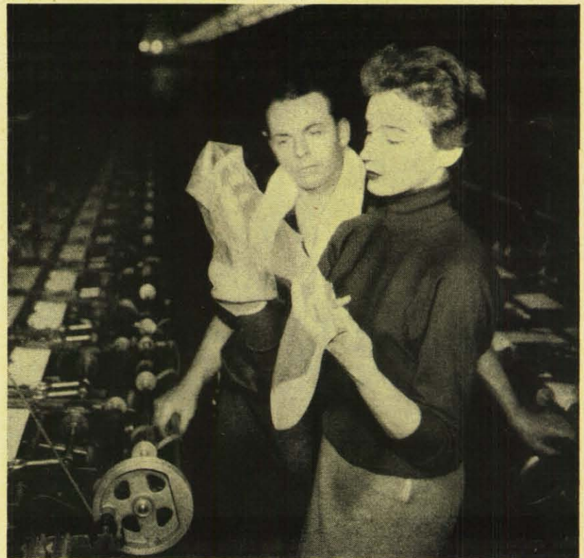
Eine der modernsten und schnellsten der deutschen Cotton-Maschinen. Sie ist erst seit Februar in Betrieb und „strickt“ Perlonstrümpfe, 15 Paar in der Rekordzeit von 40 Minuten. Die ältere „Konkurrenz“ bringt es in einer Stunde auf höchstens 8 bis 12 Paar.
