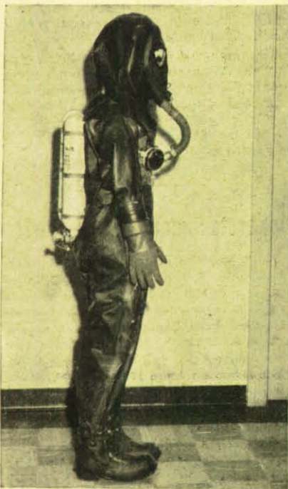
Schutzanzüge gegen hochkorrosive Treibstoffe werden von den Bodenmannschaften beim Betanken der bemannten Raketen gegen die Berührung mit Schwefelwasserstoff und flüssigem Sauerstoff verwendet.
