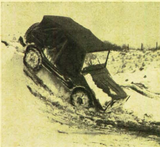
Auf Herz und Nieren geprüft wird dieser geländegängige Wagen, der für die Deutsche Bundeswehr bestimmt ist. Er hat 10 Gänge, eine Steigfähigkeit von 50% mit voller Belastung und kann Bäche durchfahren.
