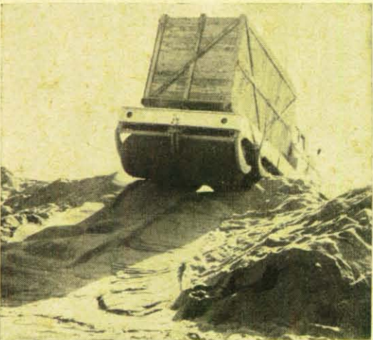
Auf Herz und Nieren geprüft wird dieser geländegängige Wagen, der für die Deutsche Bundeswehr bestimmt ist. Er hat 10 Gänge, eine Steigfähigkeit von 50% mit voller Belastung und kann Bäche durchfahren.
