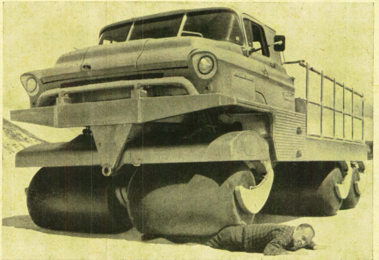
Von den Straßen unabhängig geworden ist der in Amerika entwickelte Rolligon. Er ist eine Nachbildung der primitiven Sackroller, die von den Eskimos der Bering-Straße und Alaskas benutzt werden. Die grundlegende Neuerung, die dem Wagen seine außerordentliche Geländegängigkeit verleiht, sind die „Luftkissen“, die hier die Reifen herkömmlicher Art ersetzen. Alle sechs „Luftkissen“ können vom Fahrer reguliert werden. Die Geschwindigkeit beträgt rund 65 km/h.
