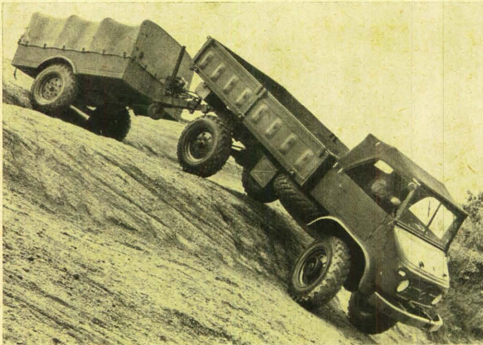
Als „Mädchen für alles“ kann man diesen von den Mercedes-Benz-Werken gebauten Unimog-S bezeichnen. Das Universalfahrzeug hat einen Radstand von 2,90 m.
