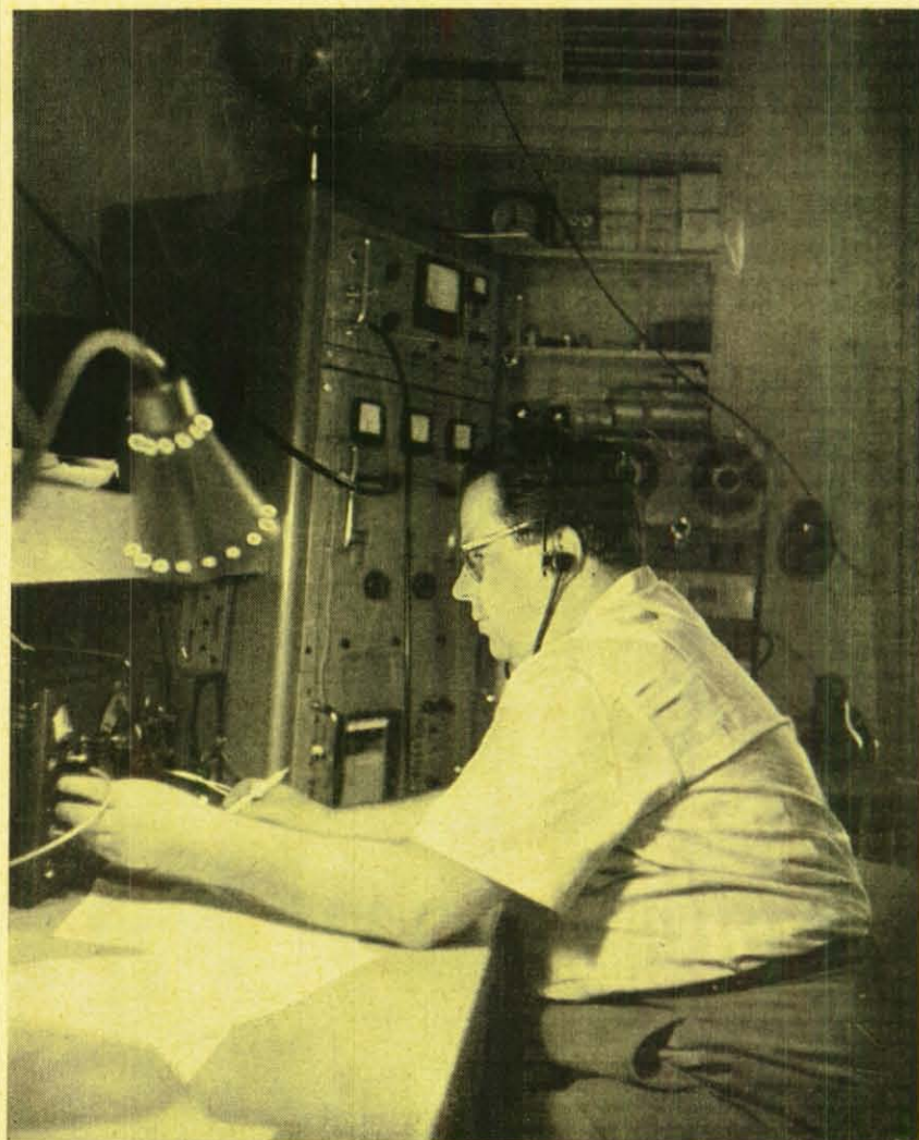
Fünfmal am Tage schaltet Hochfrequenz-Ingenieur Lengrüsser seine Geräte ein, um für je fünf Minuten die Pieptöne von „Explorer IV“ aufzunehmen. Die beiden Sendeanlagen des Satelliten können zehn verschiedene Arten von Informationen zur Erde ausstrahlen. In Bonn werden diese „Nachrichten aus dem Weltall“ auf Tonband genommen und dann auf dem Luftwege zur Auswertung nach den Vereinigten Staaten geschickt.
