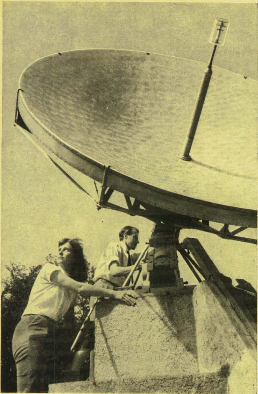
**Ein Radioteleskop**, das vor dreieinhalb Jahren auf dem Schauinsland in 1250 m Höhe ü. d. M. in Betrieb genommen wurde, zeigt die Intensität der Radiowellen an, die aus den inneren Schichten der Sonnenatmosphäre kommen. Die Wellenlänge beträgt 11,5 cm. Der Parabolspiegel aus Aluminium, mit einem Durchmesser von 3 m, wird zum Empfang der kosmischen Radiowellen ständig auf die Sonne gerichtet.
