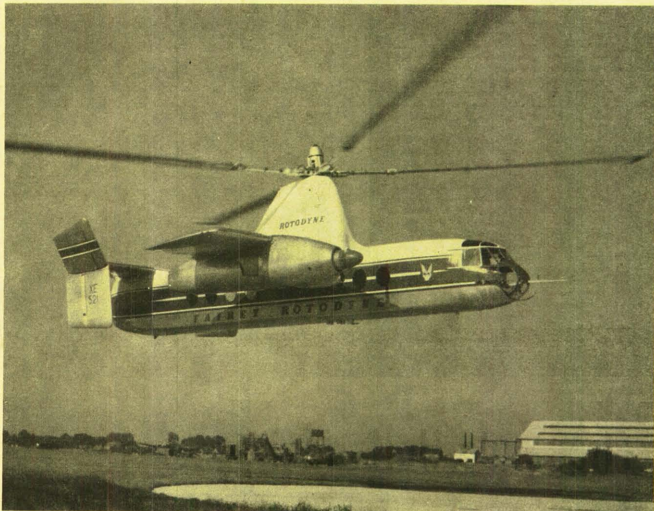
Das modernste aller Senkrechtstart-Flugzeuge ist die von den britischen Fairey-Werken entwickelte „Rotodyne“. Für den Auftrieb wird die Leistung der beiden Propellerturbinen auf den Vier-Blatt-Rotor geschaltet; im Geradeausflug liefern Luftschauben den Vortrieb
