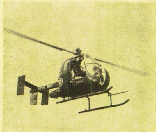
„Ultraleicht“ wird dieser von Fairey entwickelte Baby-Hubschrauber genannt. Der Rotor erhält seinen Antrieb durch eine Gasturbine, die angesaugte Luft durch die beiden Rotorenden nach außen drückt.
