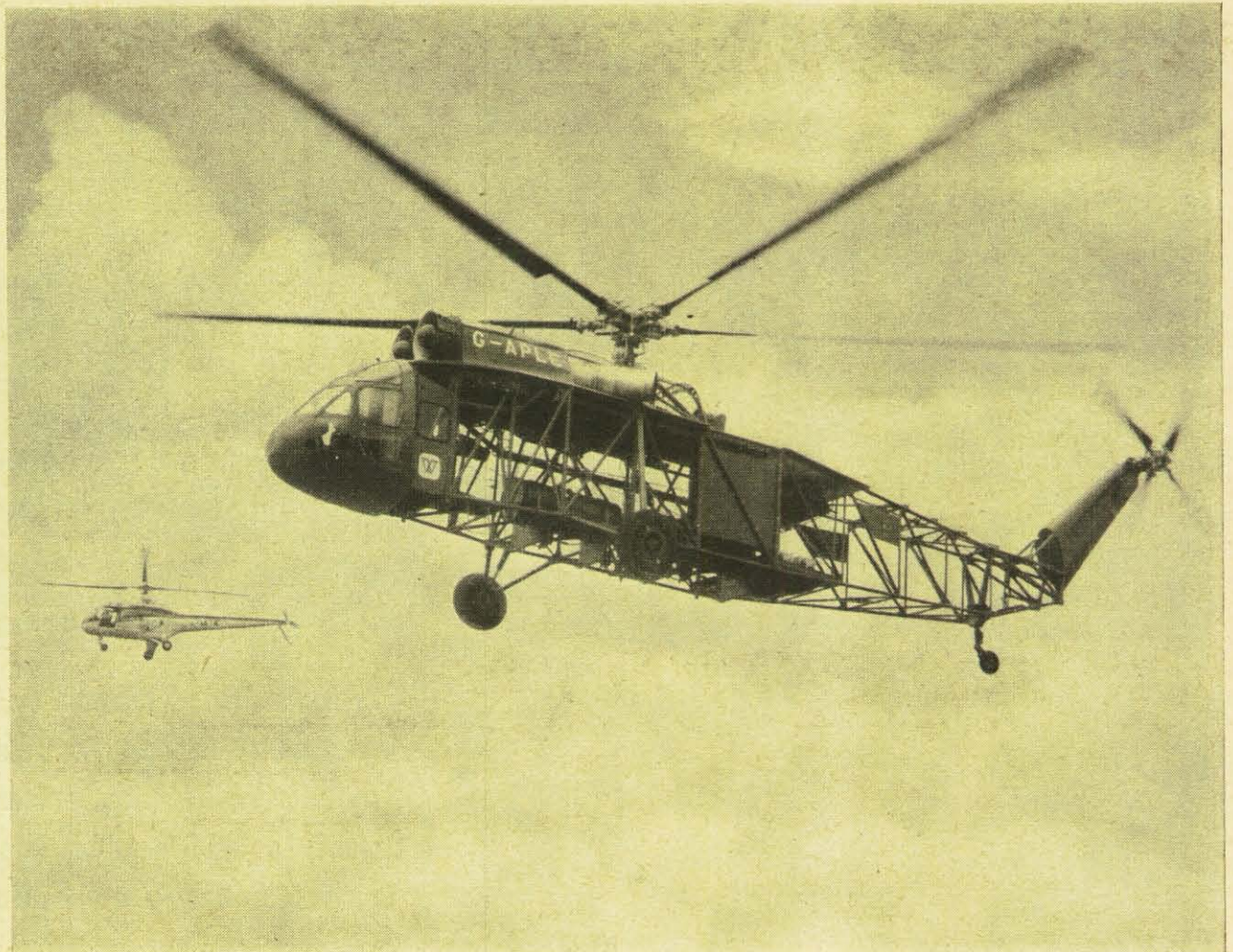
7000 Wellen-PS treiben die Westland Westminster. Diese Version soll — ohne Verkleidung — als fliegender Kran eingesetzt werden. Er ist der größte einrotorige Hubschrauber mit Turbinenantrieb, der in der westlichen Welt gebaut wird. Seine Tragkapazität beträgt sechs Tonnen! Als Truppentransporter könnte dieser Hubschrauber 51 vollausgerüstete Soldaten oder vier Jeeps aufnehmen. Die Generalstäbe versprechen sich von diesem Gerät eine Erleichterung des Nachschubs.
