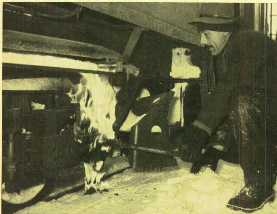
Mit Feuer müssen oftmals festgefrorene Bremsen aufgetaut werden. Beim Winterbetrieb ist der Verschleiß des Rollmaterials besonders stark. In eigenen Werkstätten wird die Sicherheit der Wagen ständig überprüft. Kaum einer der Reisenden ahnt, wieviel Arbeit geleistet werden muß, damit die Züge Tag für Tag, trotz Eis und Schnee, durch die Winterlandschaft gleiten können.
