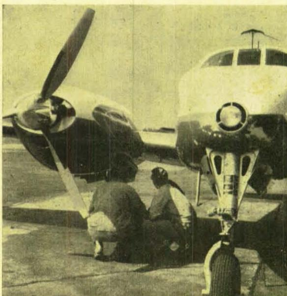
Wichtigste Vorbereitung für den Transatlantikflug ist die Außeninspektion des Flugzeuges. Ehe die angehenden Flugzeugführer eine der „Viermotorigen“ steuern dürfen, werden sie an der kleineren Beech Twin-Bonanza mit den technischen Dingen, wie z. B. Motorenkontrolle, vertraut gemacht.
