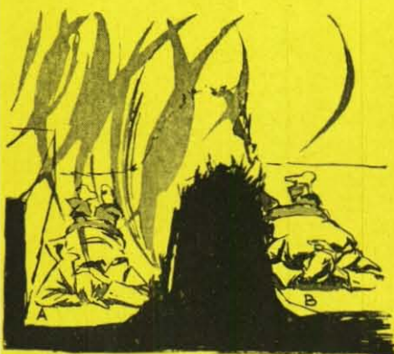
9 Infolge der Druckverdichtung zwischen zwei stabilen Hindernissen (Parkmauer und Hügel) ist A viel stärker gefährdet als B.
