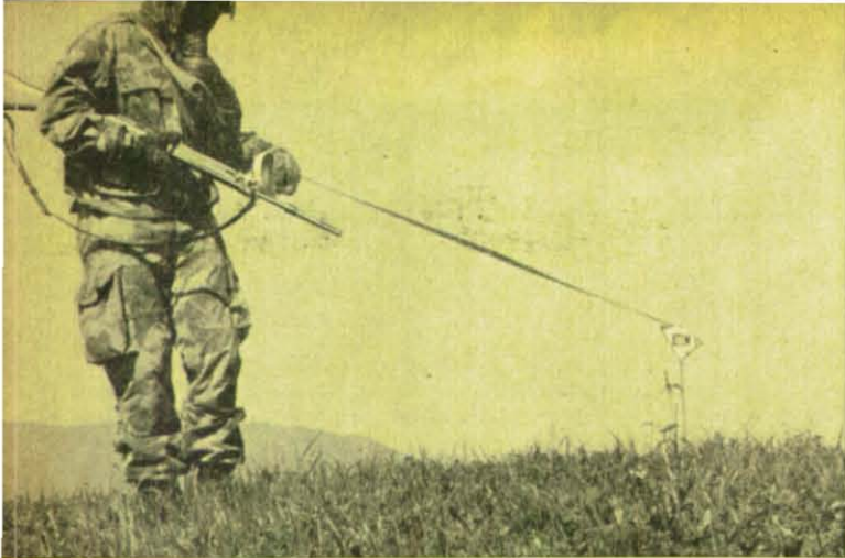
Der Strahlenspürtrupp zu Fuß hat die vordere Grenze eines radioaktiv vergifteten Geländes erreicht und markiert sie. Auf der Rückseite des Schildes wird die Strahlungsintensität vermerkt.
