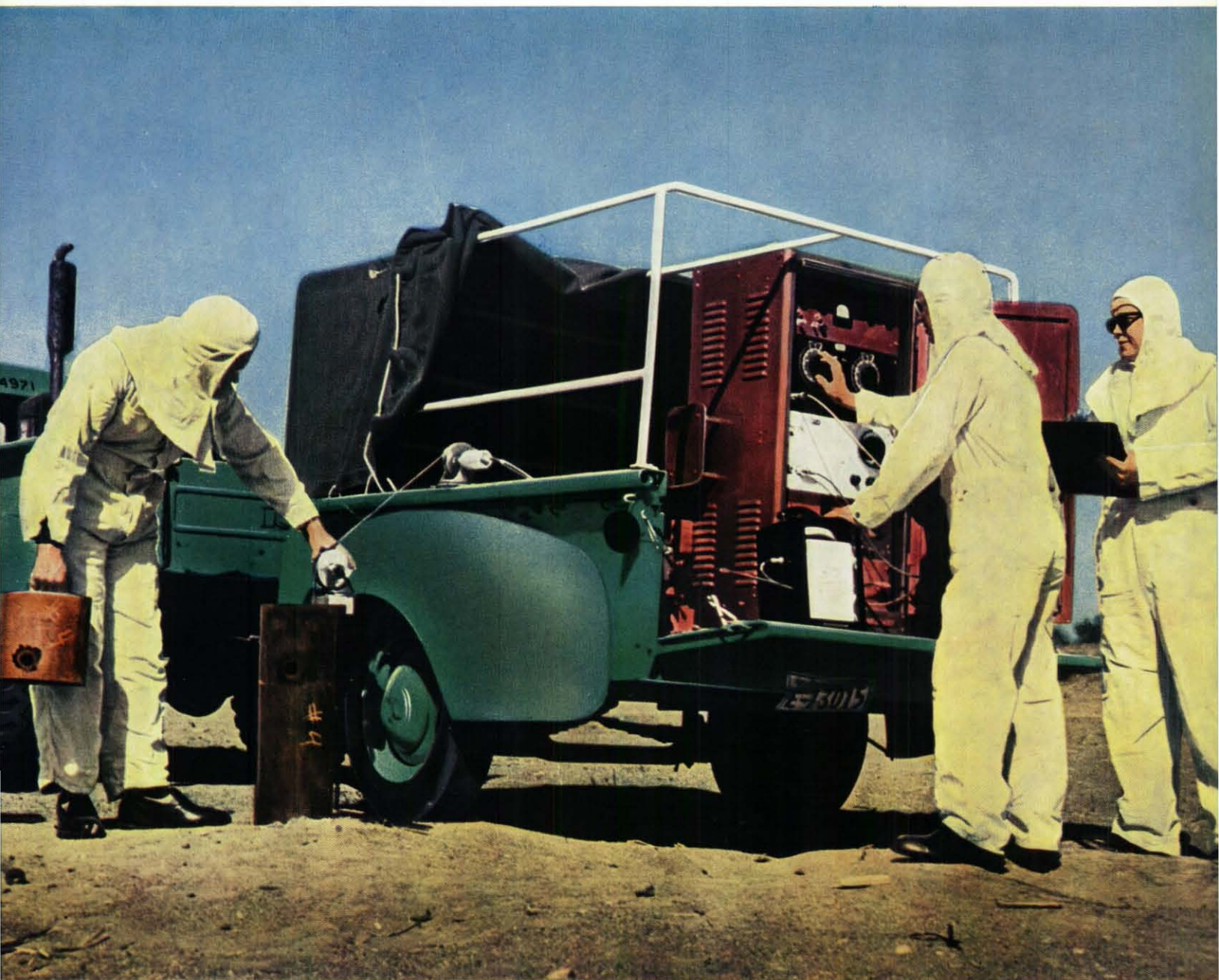
Auf „heißer“ Fährte. Ein Spezialtrupp der US-Zivilverteidigung mißt mit einem Großgerät die Radioaktivität des Grundwassers / Zu unserem Bericht auf Seite 10
